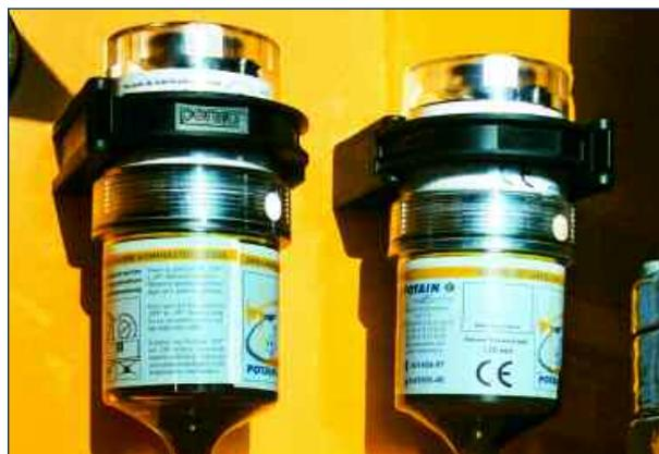
Automatische Schmierung des Drehkranzes (innen)
