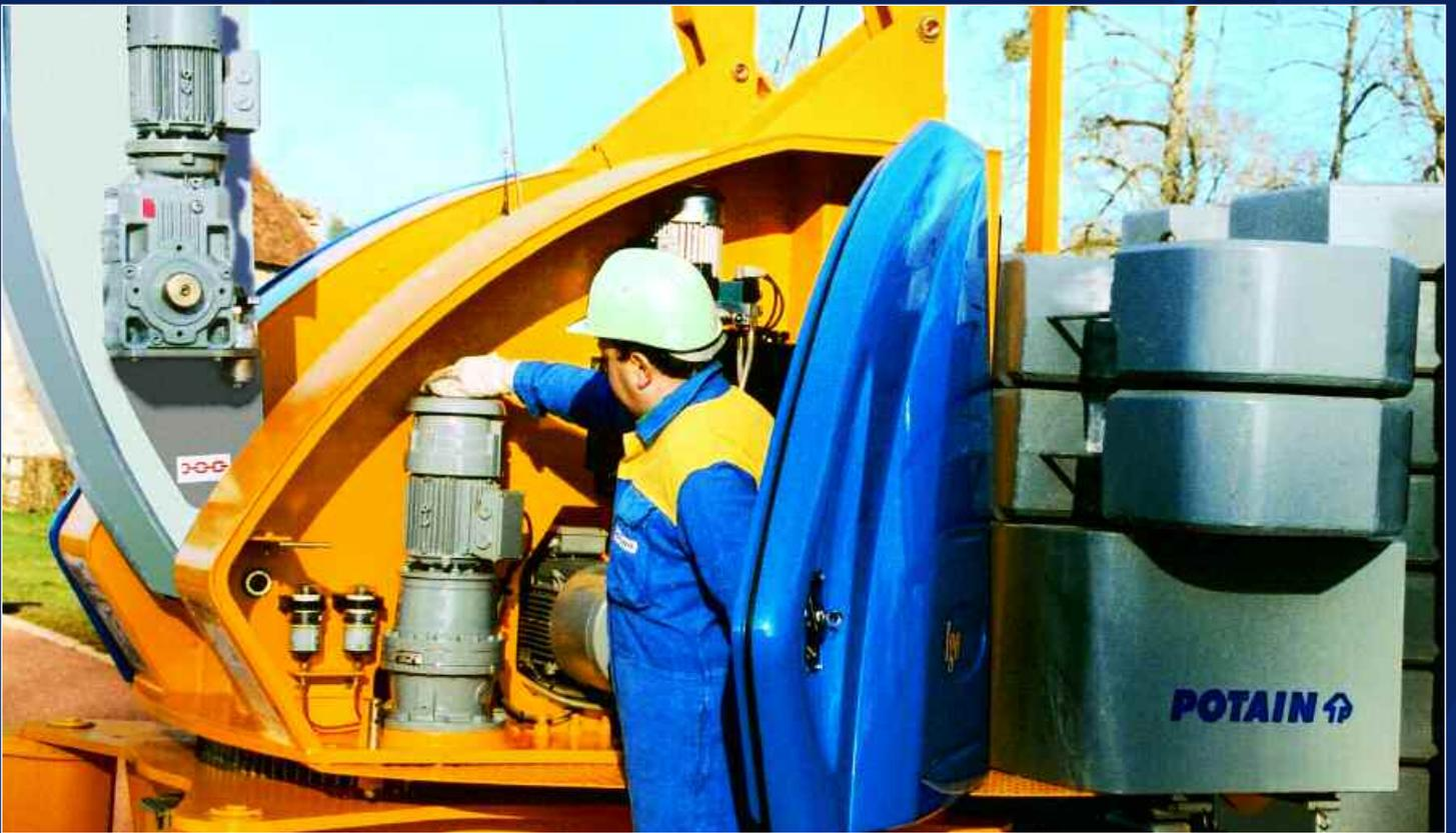
Zugang zur Hydraulikanlage und Steuerung der Windfreistellung
